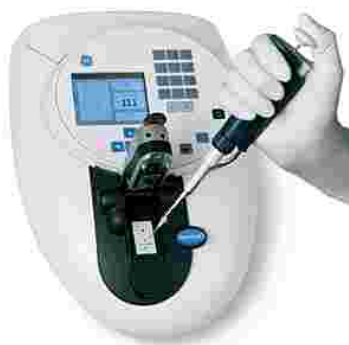
Figura. 1 - Espectrofotômetro Nanovue Plus utilizado para a quantificação de DNA das amostras da coorte de indivíduos em Pelotas/RS-Brasil no ano de 1993.
