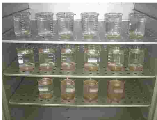
Figura 2 – Conjuntos de beakers e solução colocados na estufa para secagem.
