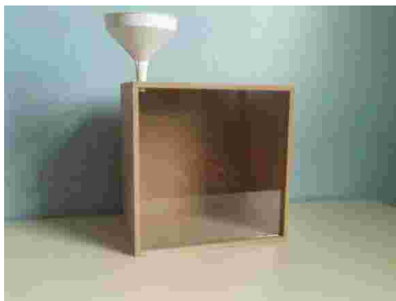
Figura 1. Plataforma e funil utilizados na determinação do ângulo de repouso
